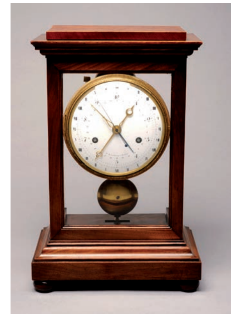
Pendule à temps décimal et sexagésimal, 1794, de Pierre Basile Lepaute, horloger à Paris. CNAM.
