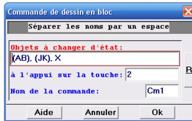
Faire de même avec les deux autres couples de droite et créer un commande permettant de masquer//afficher la droite d. Des pressions sur les touches 1,2,3,4 permettent indépendamment l'affichage ou non des différents éléments clefs de la figure. La touche 1 affiche ou non la droite d'intersection (d).
